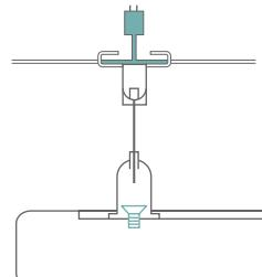
Nach der Montage eines Akustikpaneels entsteht ein Abstand von 10 mm zwischen dem Paneel und der Wand.
